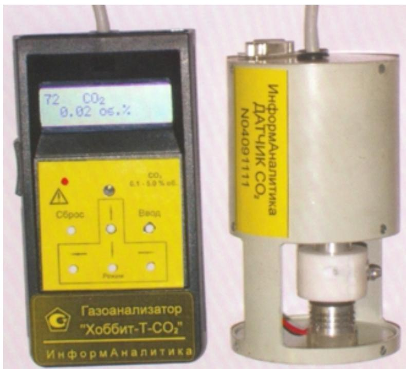
Рис.136. Газоанализатор «ХОББИТ-Т»
