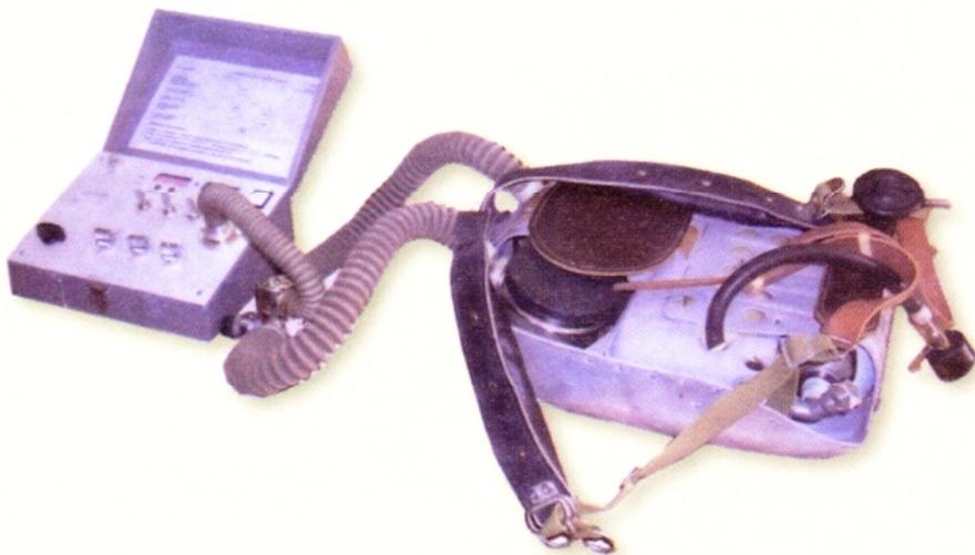
**Рис.112. Электронный индикатор ИПР-Э с проверяемым респиратором**
