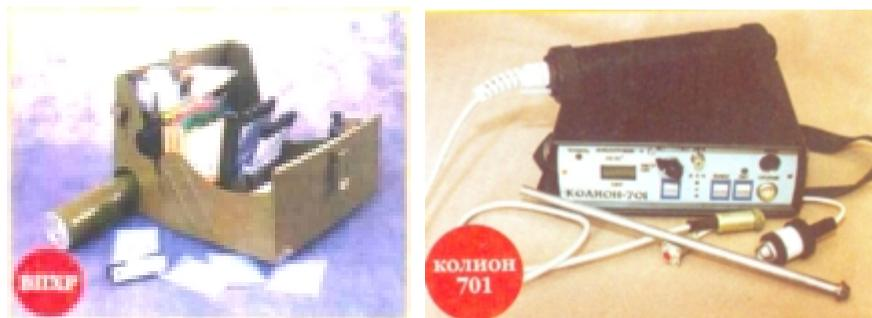
Рис.127. Прибор химической разведки и газоанализатор
