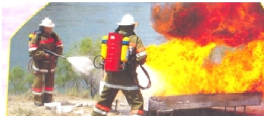
Рис. 101.Тушение очага пожара с помощью «РУПТ-1-0,4» («ИГЛА-1-0,4»)
