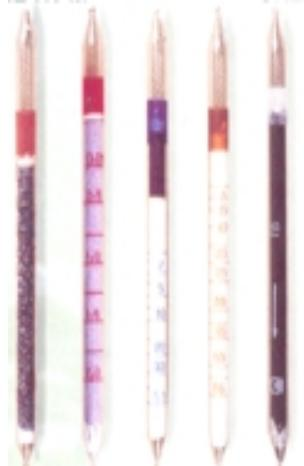
Рис. 147. Трубки индикаторные
