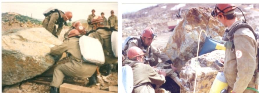
Рис.186. Применение пневмомократов типа «пневмоподушка»
