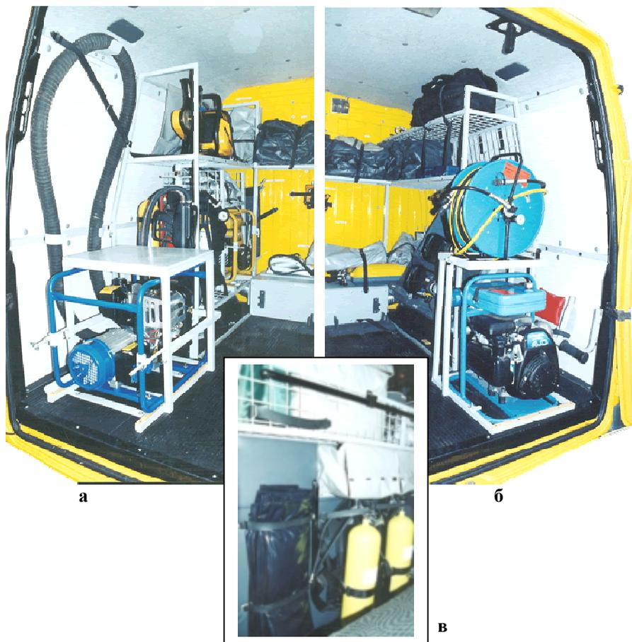
**Рис.156. Размещение оборудования на автомобиле: а - по левому борту; б - по правому борту; в - на перегородке технического отсека**
