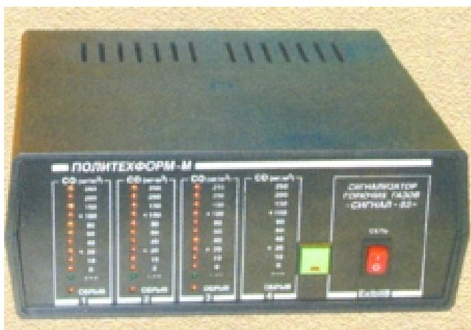
Рис.132. Газоанализатор – сигнализатор СИГНАЛ-03 СО
