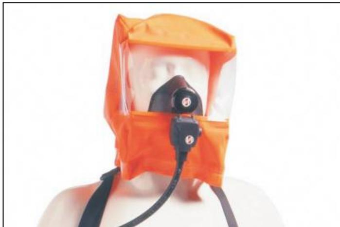
Лицевой частью спасательного устройства с постоянной подачей воздуха является капюшон с подмасочником и клапаном выдоха. Шланг с дюзой и ниппелем служит для подключения к воздуховодной системе аппарата и создания постоянной подачи воздуха под капюшон.
