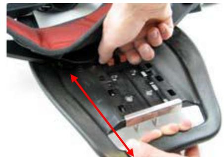
Спинка состоит из анатомической рамы, сделанной из высокопрочного конструкционного полимера, поясного ремня, нейлоновых плечевых ремней и универсальной текстильной системы для крепления одного или двух баллонов диаметром от 140 до 183 мм. Два шарнирных элемента смонтированы на спинке в области пояса с обеих сторон. К ним крепятся плечевые ремни. С обратной стороны рамы крепится с
