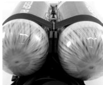
8. Зафиксируйте баллоны на тройнике. Это сделать легче, когда тройник не затянут на редукторе и может немного вращаться. Затяните тройник после затяжки каждого из баллонов.
