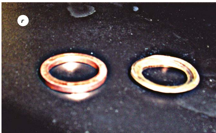
Рис 3. Последствия аварии в ООО «Коминтех»: а – общий вид места происшествия; б – место начала истечения кислорода; в – нижний участок трубопровода; г – прокладка
