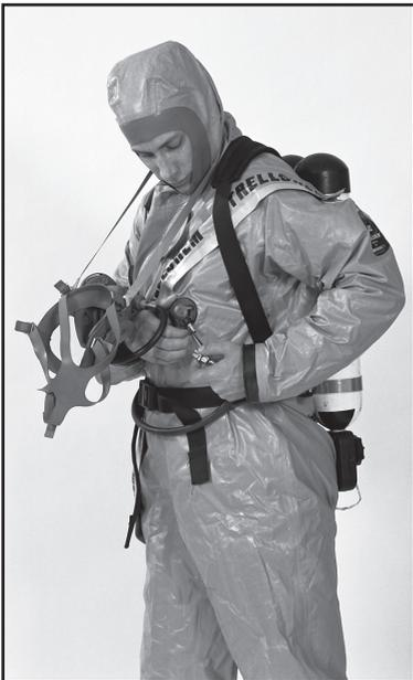
8. Подсоедините вентиляционный шланг к впускному (регулирующему) клапану.
