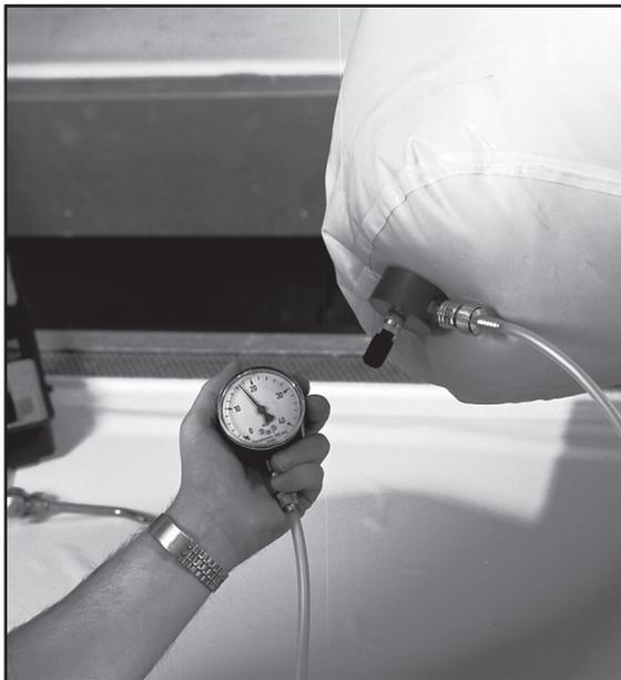
4. Наполните костюм воздухом через клапан на переходнике. Проведите проверку в соответствии с указаниями раздела «Информация об испытаниях под давлением».
