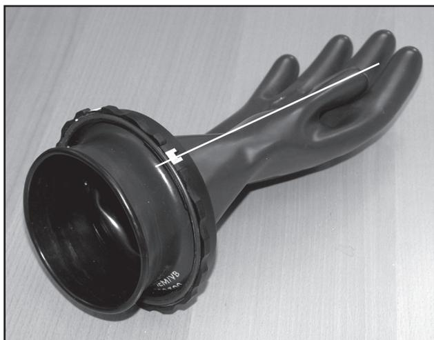
8. Отсоединение перчатки производится путем выполнения соответствующей процедуры в обратном порядке. Внутренняя перчатка приклеивается к наружной, но расклеить эти перчатки можно, прилагая незначительное усилие. В случае если внутренняя перчатка не отклеивается, отклеивайте поочередно, палец за пальцем, и выворачивайте ее наизнанку.
