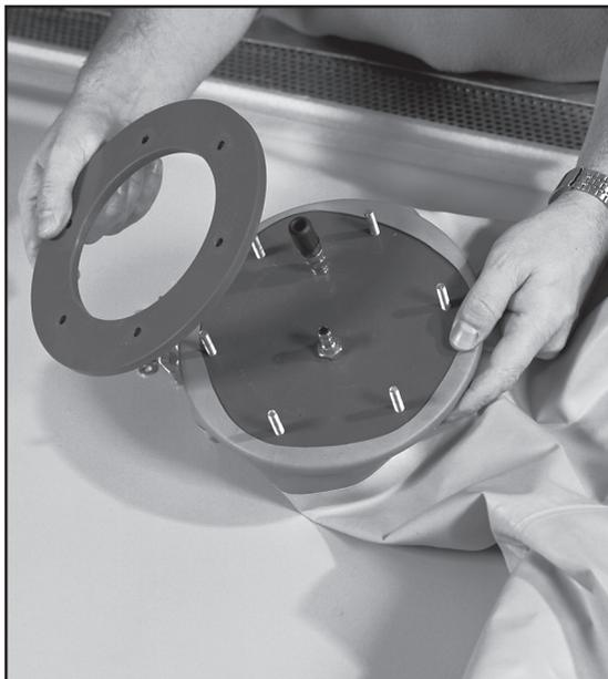
4. Застегните застежку-молнию. Подключите манометр через ниппель к пластине лицевого уплотнителя. Наполните костюм воздухом в соответствии с указаниями раздела «Информация об испытаниях под давлением».
