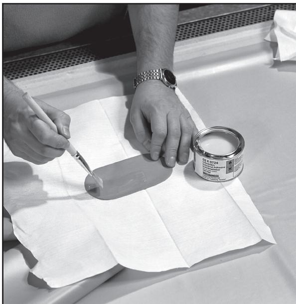
6. ...и на заплату. Дайте клею просохнуть в течение 5-10 минут до тех пор пока не появятся клейкие свойства. **Важная информация:** Повторите этот и предыдущий пункт, и нанесите второй слой клея. Дайте клею просохнуть до появления клейкости.
