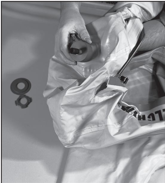
1. Разложите костюм на чистой, гладкой поверхности. Удалите выпускной клапан и вставьте переходник (используется для костюмов типа TE/VP1/CV).
