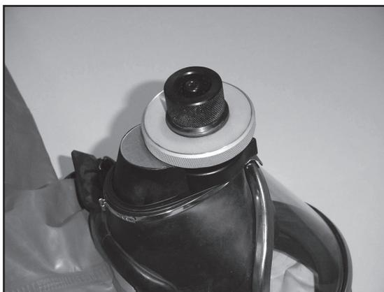
3. Застегните застежку-молнию и присоедините манометр к переходнику. Наполните костюм воздухом через клапан на переходнике. Проведите проверку в соответствии с указаниями раздела «Информация об испытаниях под давлением».
