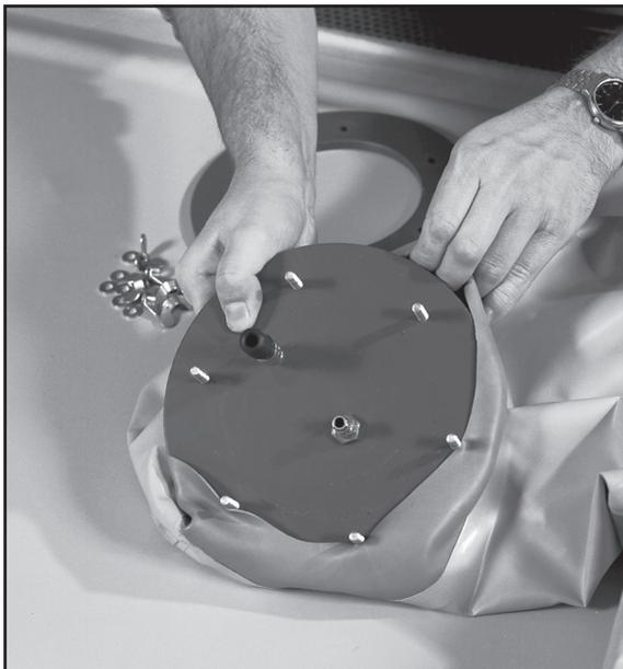
2. Вывинтите гайки пластины лицевого уплотнителя и снимите верхнее кольцо. Установите пластину под лицевой уплотнитель (изнутри). Отрегулируйте лицевой уплотнитель таким образом, чтобы он накрывал наружную часть пластины, но не касался винтов.
