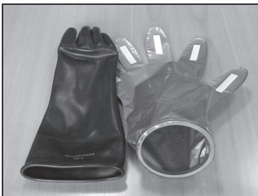
2. Снимите защитную пленку с каждого пальца внутренней перчатки. Это позволит открыть клейкую зону, с помощью которой внутренняя перчатка будет фиксироваться на месте, внутри наружной перчатки, при надевании перчатки на руку.
