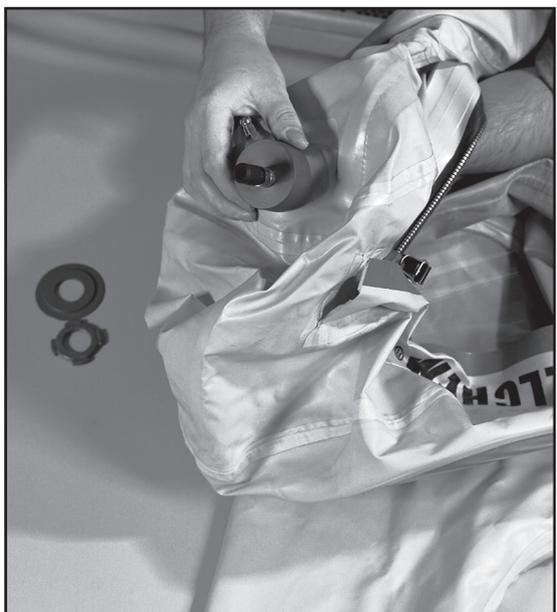
2. Вставьте пробки в другие выпускные клапаны. Для костюмов старого образца с выпускными клапанами серого цвета используется маленькая пробка. Обратитесь к дистрибьютору компании-производителя.
