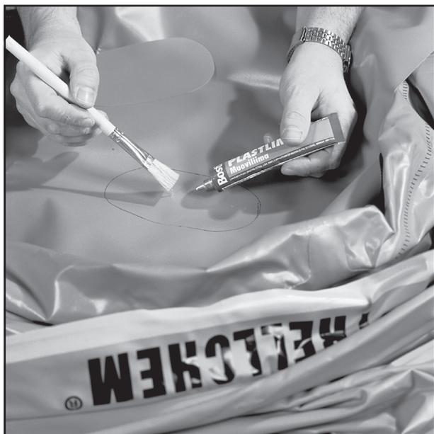
4. Нанесите тонкий слой клея на поврежденную зону и
