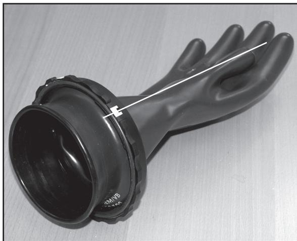
2. Протяните перчатку через кольцо перчатки и совместите большой палец перчатки с зеленой меткой на кольце. Установите ее на место большими пальцами. Для получения дополнительной информации по соединению перчатки с костюмом см. раздел «Открытое положение (соединение/разъединение)».
